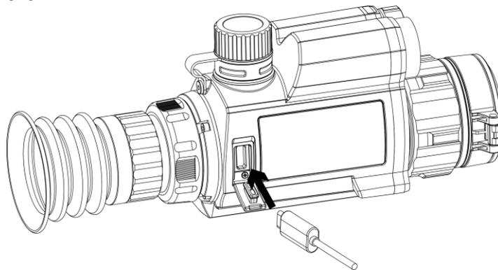
Abbildung 2-1 Kabelverbindung
