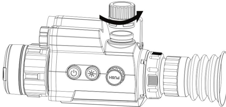
**Abbildung 2-2 Akkufachdeckel öffnen**
