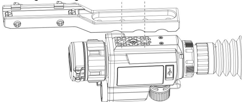
**Figure 2-5 Montagebohrungen ausrichten**
