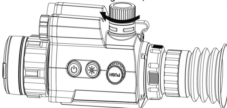
**Figure 2-4 Akkufachdeckel schließen**
