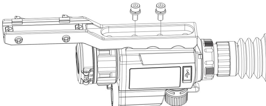
**Abbildung 2-6 Schrauben einsetzen**
