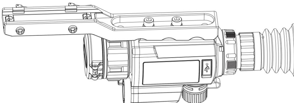
**Abbildung 2-7 Schrauben festziehen**
