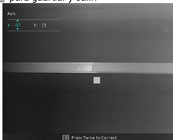
Figura 3-4 Corrección de píxeles defectuosos
