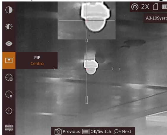
Figura 3-4 Impostazione della modalità Picture in Picture
