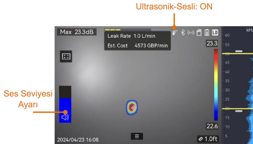
Şekil 5-4 Ultrasonik-Sesli ve Ses Düzeyi Ayarı
