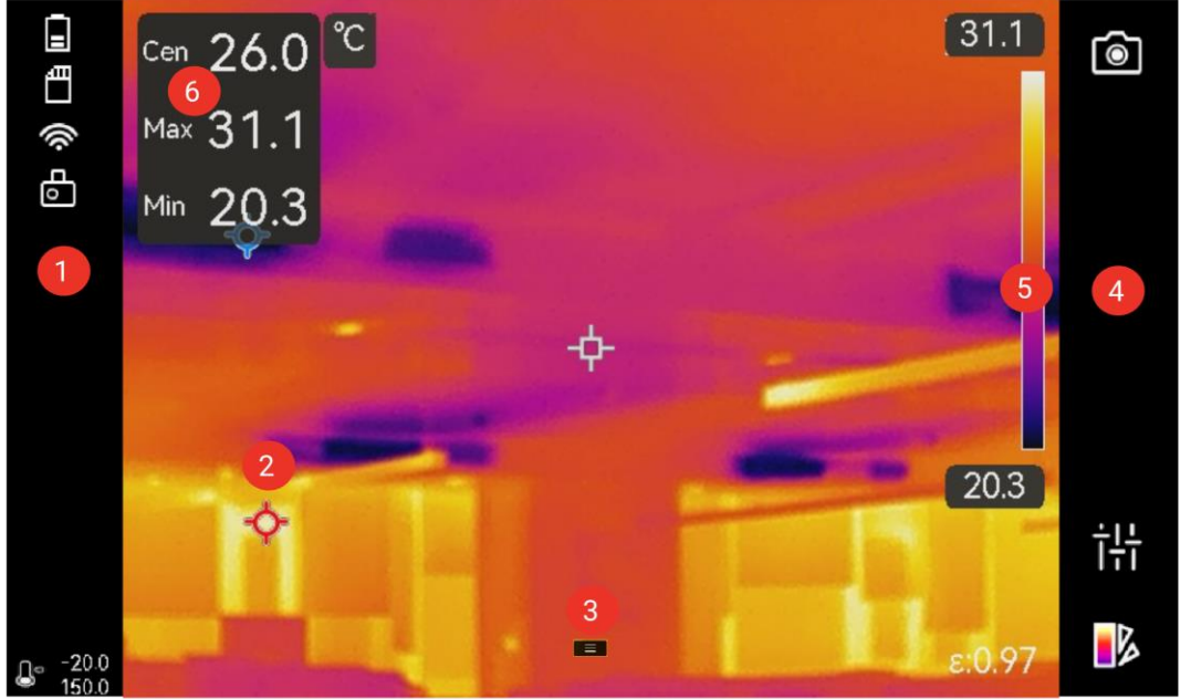
Şekil 2-11 Termal Görüntü Modunun Canlı Görüntüleme Arayüzü
