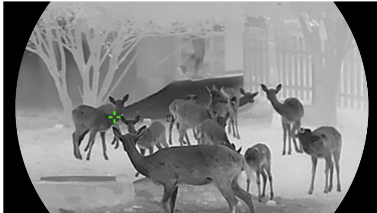
Figura 6-1 Seguimiento de alta temperatura
