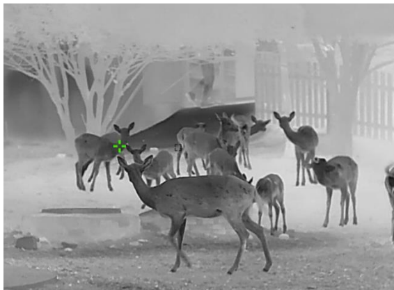
Abbildung 5-3 Stelle mit höchster Temperatur verfolgen
