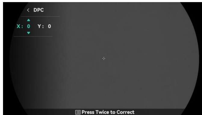
Figura 3-6 Corrección de píxeles defectuosos
