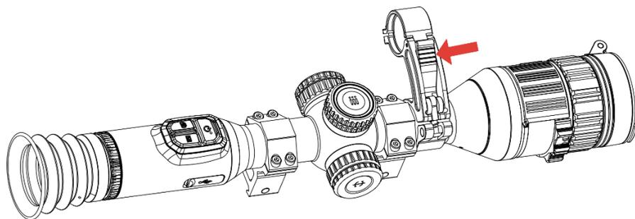
Figura 2-11 Bloquear la palanca
