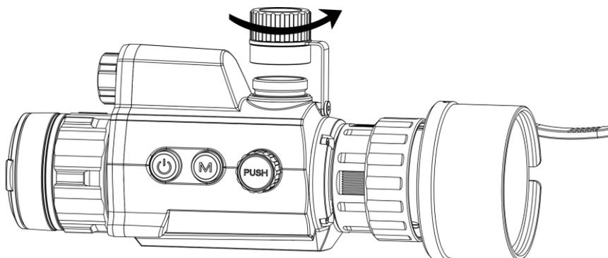
**Abbildung 2-3 Akkufachdeckel öffnen**
