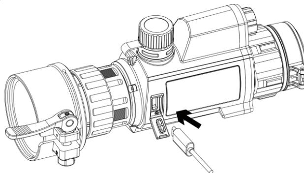
Abbildung 2-1 Kabelverbindung
