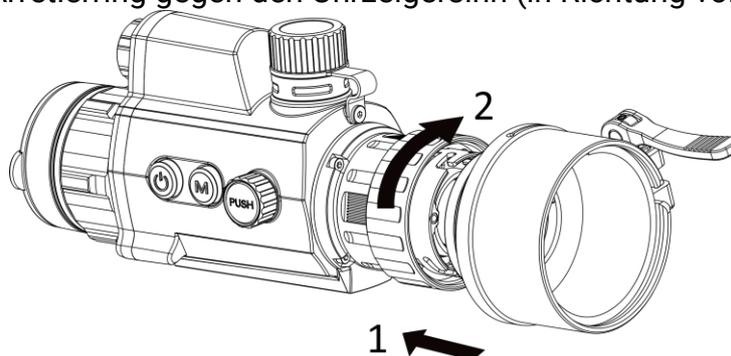
Abbildung 2-2 Adapter installieren
