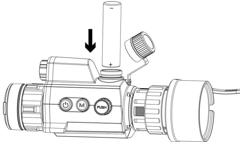
**Abbildung 2-4 Akku einsetzen**
