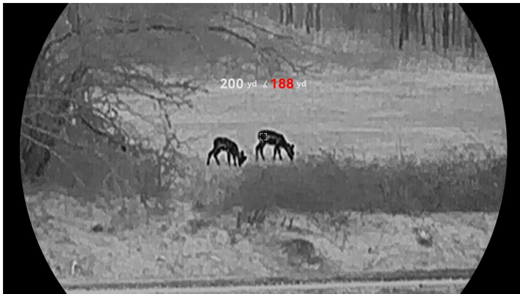
Рис. 4-1 Результат измерения расстояния
