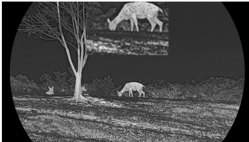
3-4. ábra: PIP mód beállítása
