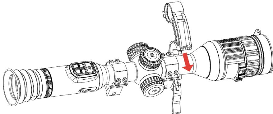
Figure 2-10 Ouverture du support de la torche IR
