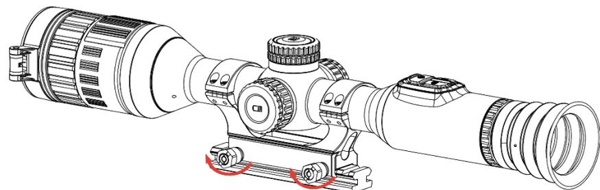
Figure 2-9 Serrage des vis
