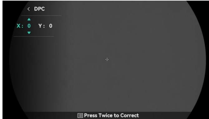
3-6. ábra: Hibás képpontok kijavítása
