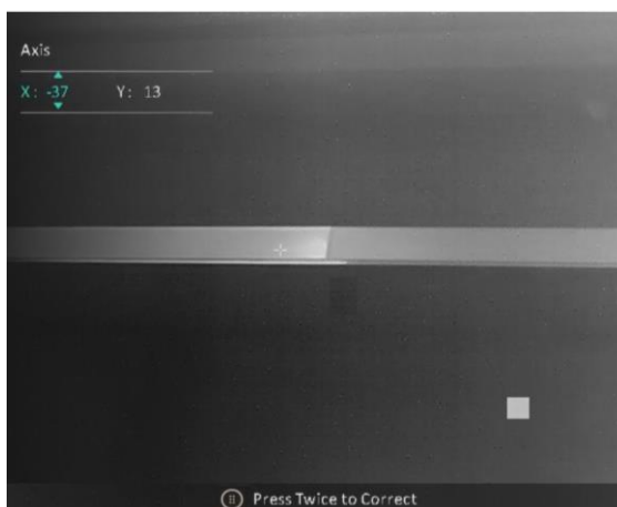
Figura 3-6 Correção dos pixéis defeituosos
