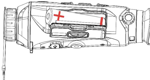
Figura 2-2 Insertar la pila
