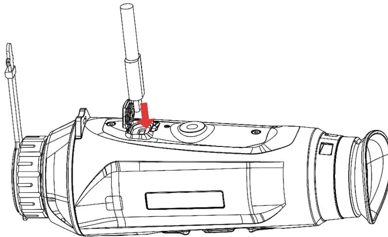
Figura 2-4 Conexión del cable
