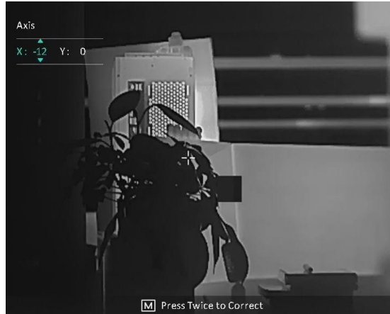
Figur 3-6 Riktig defekt piksel
