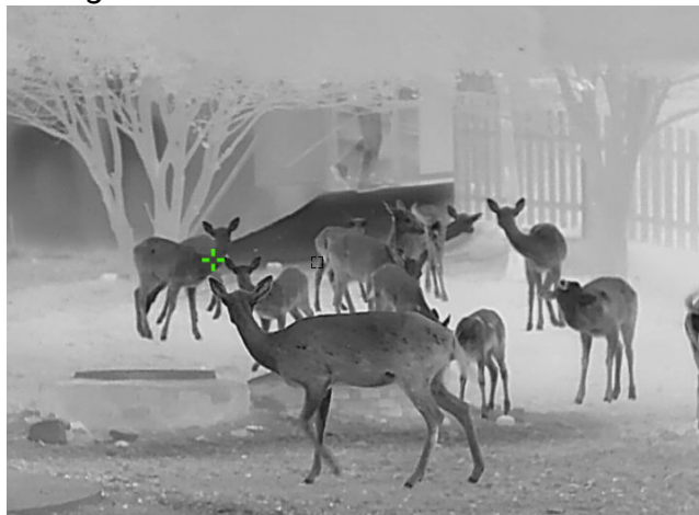
Abbildung 5-5 Stelle mit höchster Temperatur verfolgen
