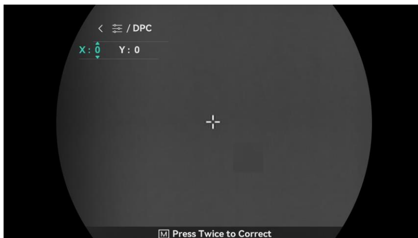
3-6 pav. Defektinio pikselio taisymas
