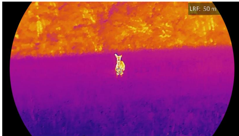
Abbildung 4-1 Ergebnis der Laser-Entfernungsmessung
