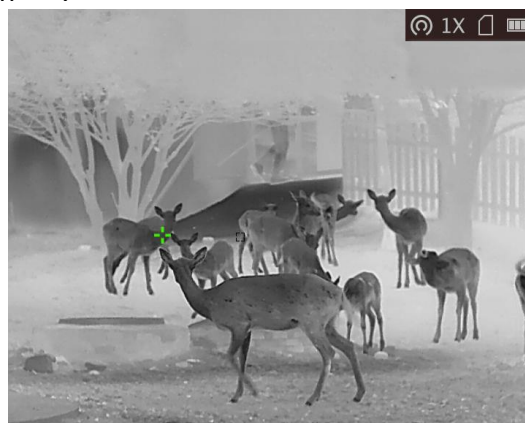
Abbildung 5-3 Stelle mit höchster Temperatur verfolgen
