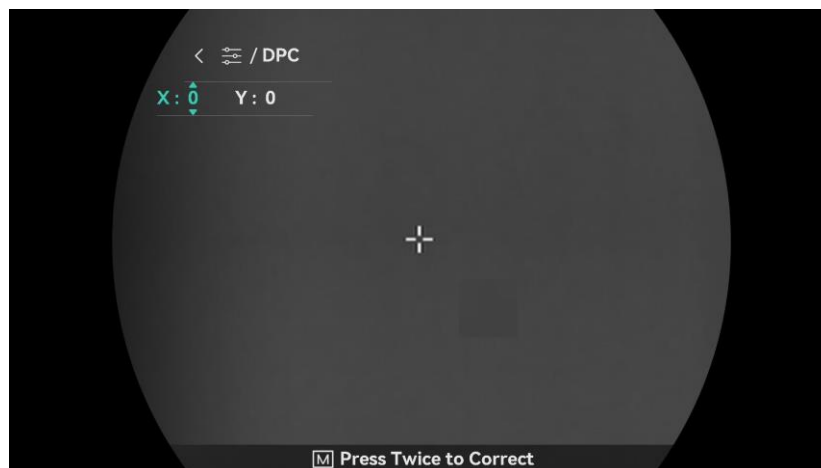
Figur 3-6 Korrektion af defekt pixel
