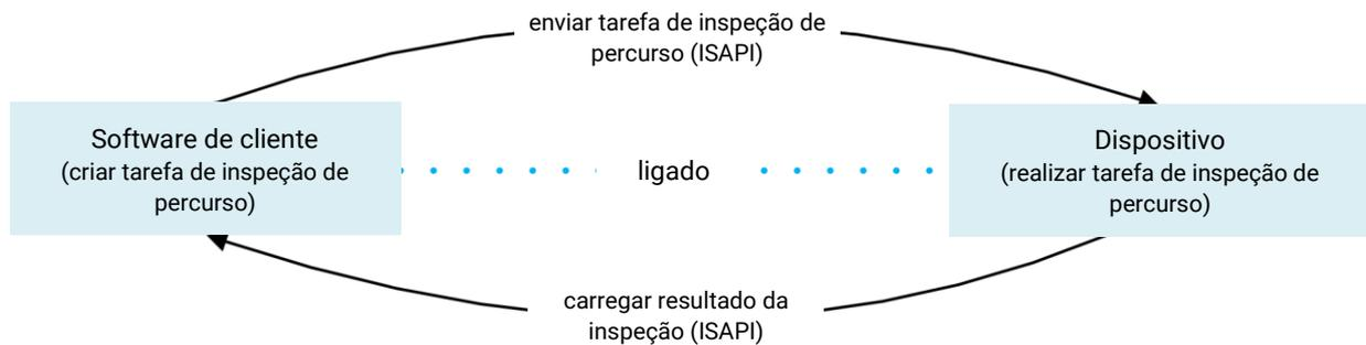
Figura 5-1 Fluxo de trabalho da inspeção de percurso
