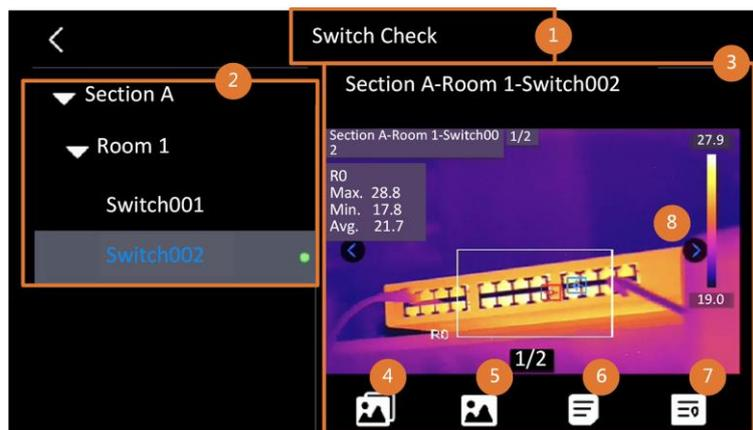
Figura 5-2 Fluxo de trabalho da inspeção de percurso
