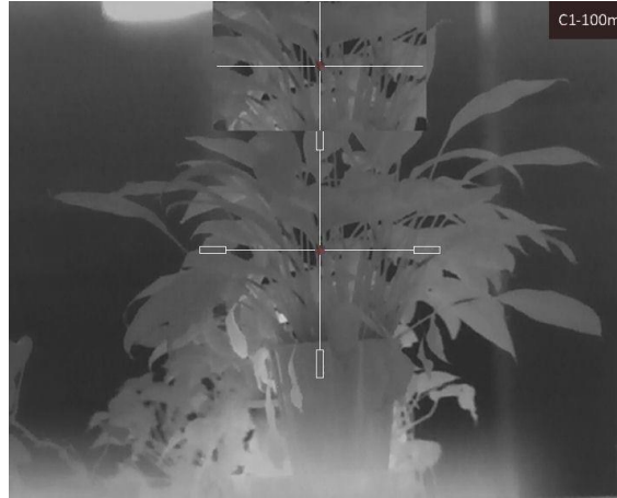
Figur 4-2 PIP-effekt for korrigering med retikkel
