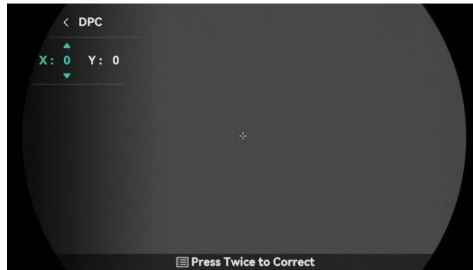
Abbildung 3-6 Defekte Pixel korrigieren
