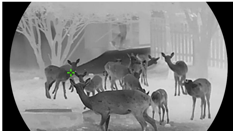
Abbildung 5-2 Stelle mit höchster Temperatur verfolgen
