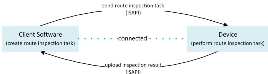
Figura 7-1 Fluxo de trabalho da inspeção de percurso
