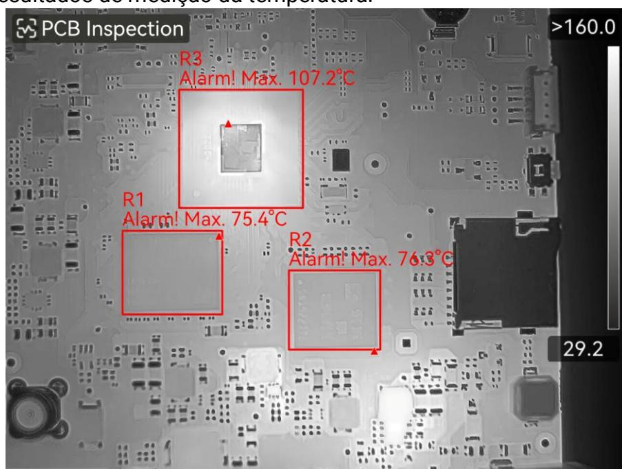
Figura 5-1 Inspeção PCB
