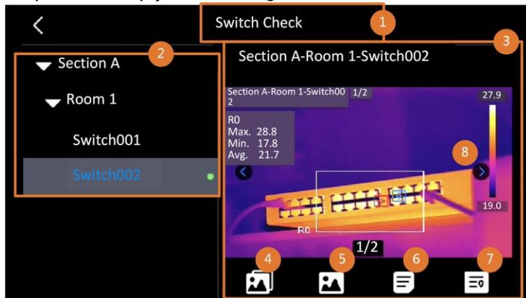
Figura 7-2 Fluxo de trabalho da inspeção de percurso
