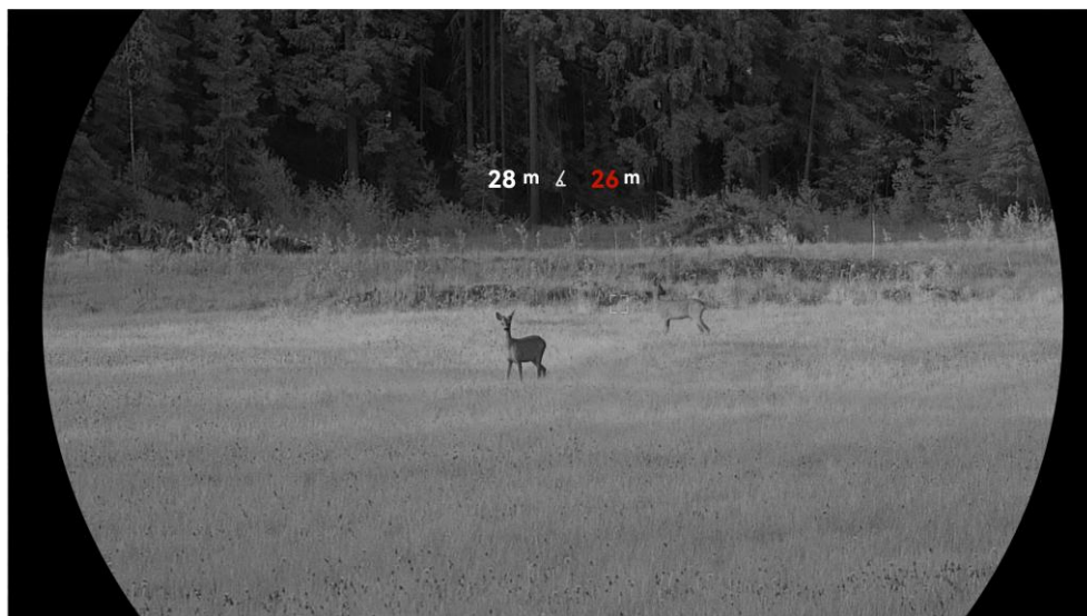
Obrázok 4-1 Výsledok merania vzdialenosti laserom
