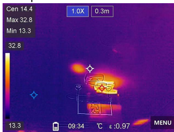
Figura 3-2 Regolare la correzione della parallasse
