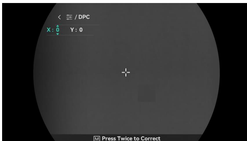
Figur 3-6 Riktig defekt piksel
