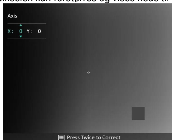
Figur 3-5 Korrigerer defekt piksel
