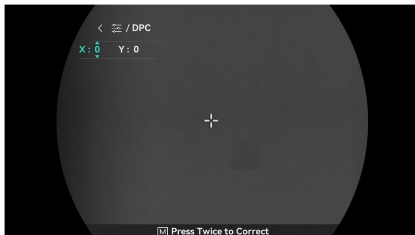
Figur 3-5 Riktig defekt piksel
