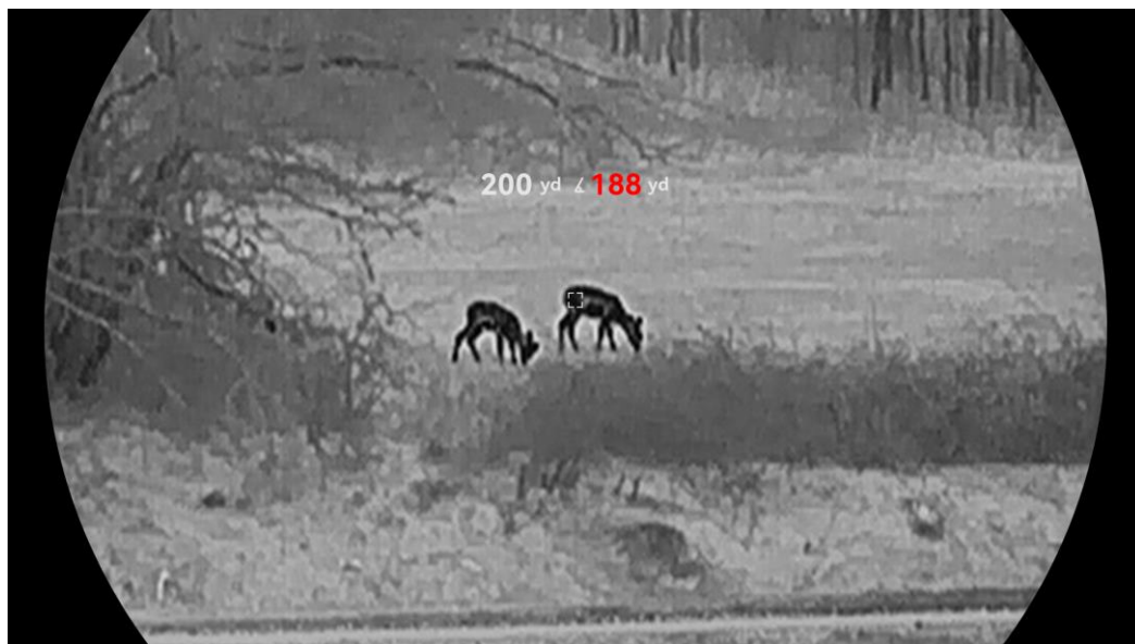
Figura 4-1 Risultati della misurazione della distanza
