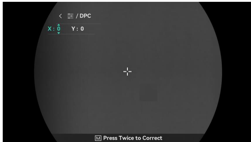
Figura 3-6 Corrección de píxeles defectuosos
