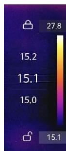
Figura 3-10 Ajuste solo del nivel
