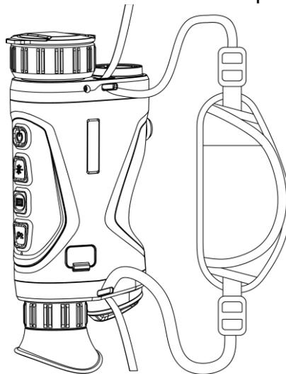
Figura 2-5 Pase la correa de mano por el punto de fijación
