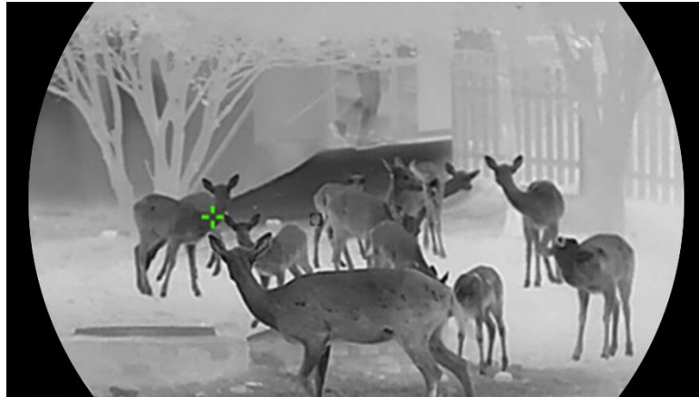
Figura 5-2 Seguimiento de calor
