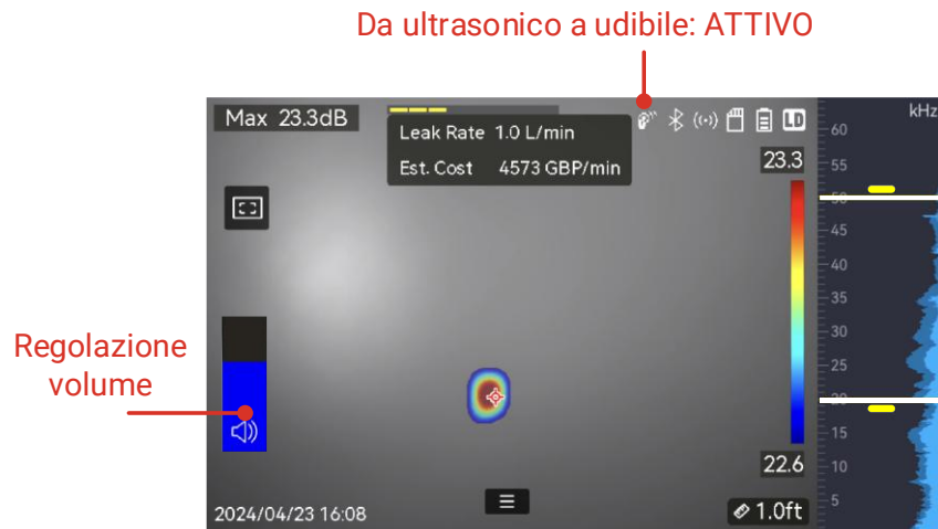
Figura 6-6 Da ultrasonico a udibile e regolazione del volume
