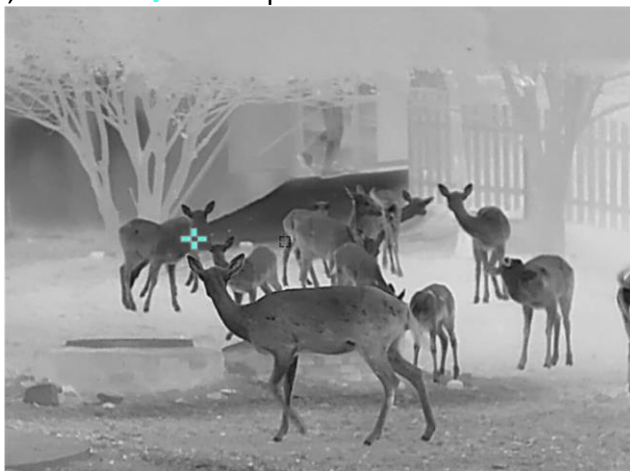
Figura 6-3 Seguimiento de calor
