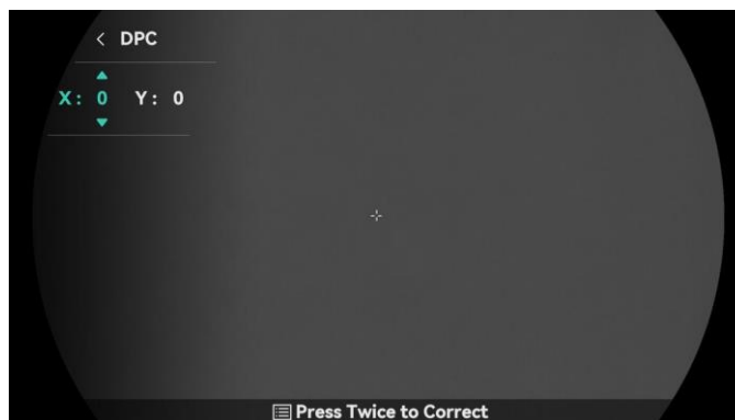
Obrázok 3-6 Korekcia chybných pixelov
