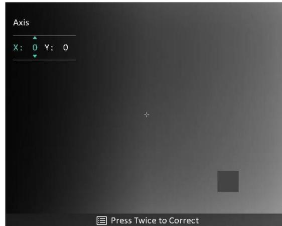
Figura 3-5 Correzione dei pixel difettosi
