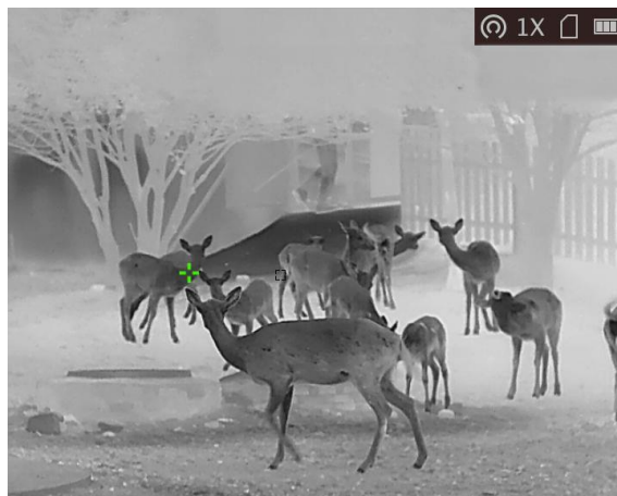
Figura 6-3 Effetto del tracciamento del punto più caldo
